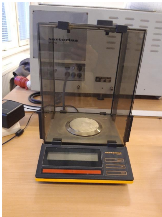
12. ábra: Sartorius A200S típusú analitikai mérleg (Forrás: HALÁSZ, 2024)
