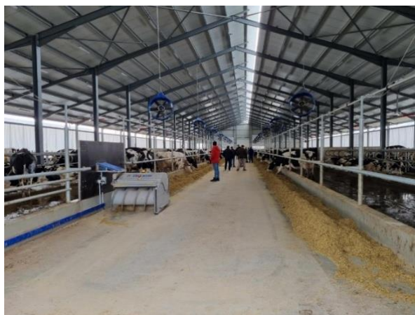
8. ábra Takarmányrendező robot az istállóban (Forrás: saját fotó)
