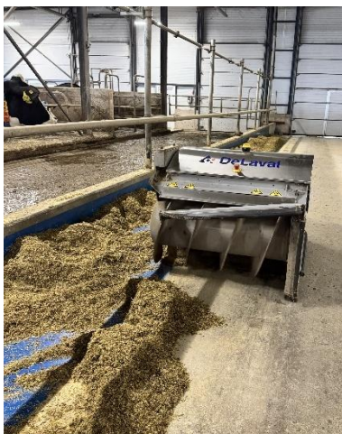
9. ábra Takarmány toló és forgató robot Forrás: (Saját kép 2025)
