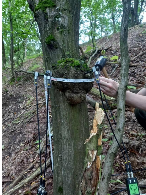
7. ábra. A Fakopp ArborSonic 3D akusztikus tomográf működés közben (saját fénykép, 2023).
