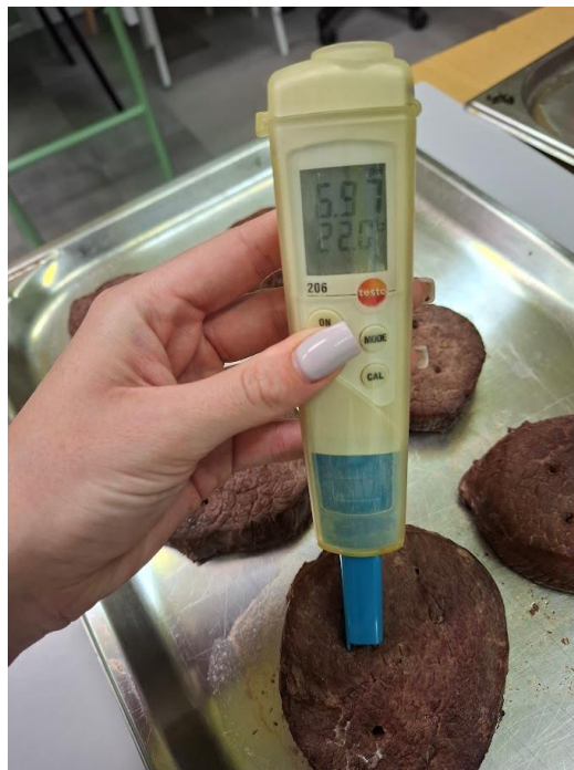
29. ábra: pH mérése Testo 206-pH1 mérővel
