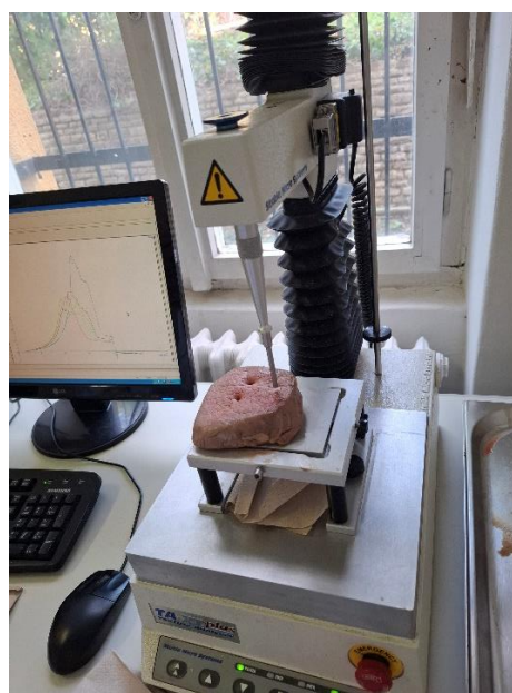
30. ábra: SMS TA XT plus állománymérőberendezés
