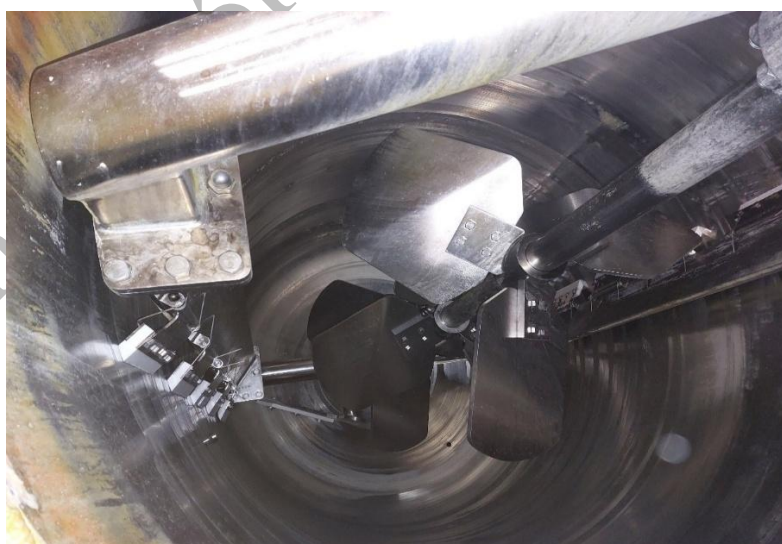
3.ábra. Anker keverős mixer (forrás:saját)
