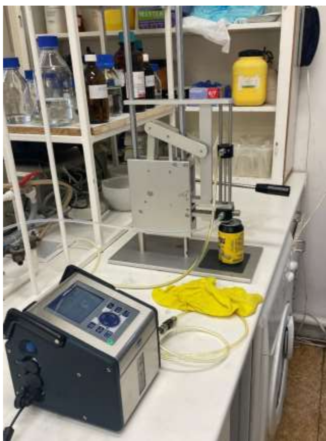
7. ábra: Dobozos sör oldott oxigén tartalmának mérése laboratóriumi keretek között
