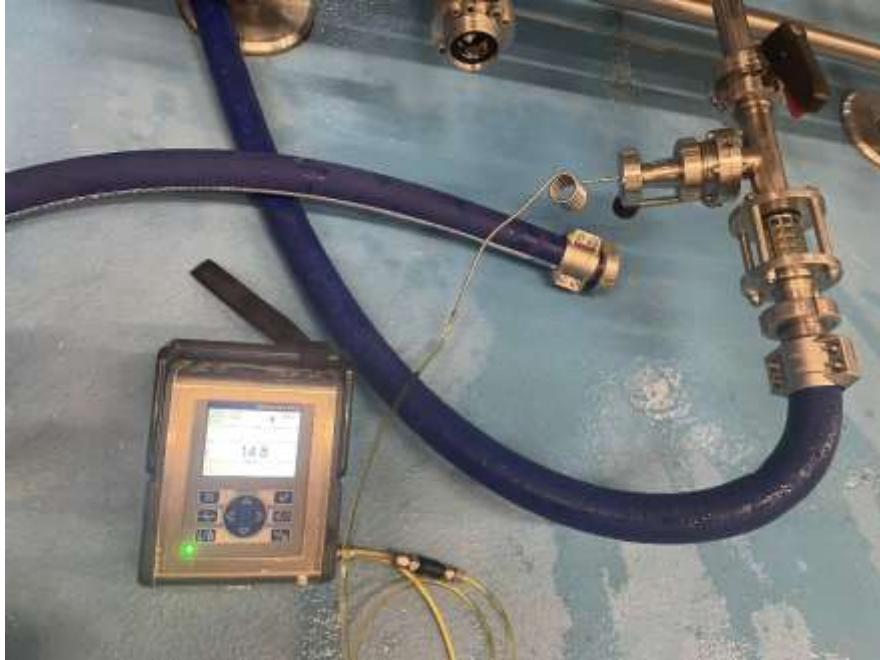
5. ábra: Oldott oxigén mérés a kiszereelő tartály alsó csonkjánál
