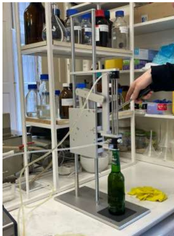
6. ábra: Palackba fejtett sör oldott oxigén mérése
