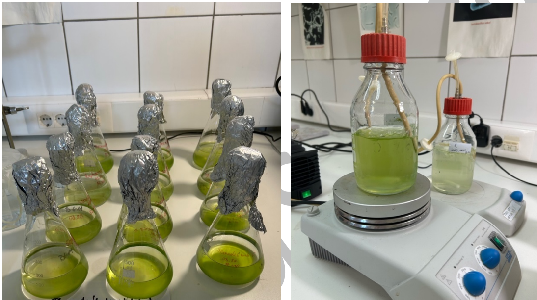
10.ábra: Szakaszosan ráztatott (a) és levegőztetett-kevertetett (b) laboratóriumi alga reaktor
