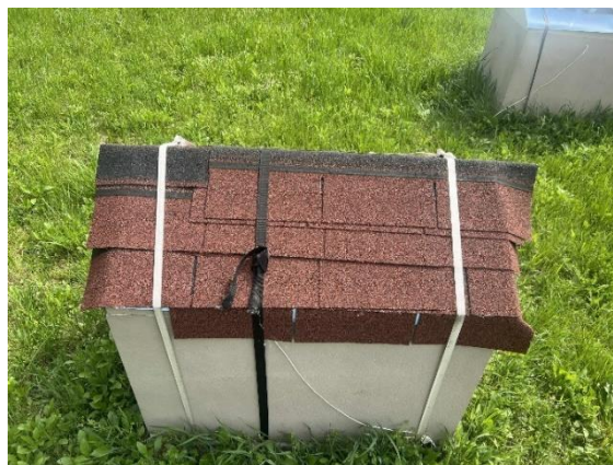
13.Ábra: Zsindely rögzítése a modellházon (saját kép)
