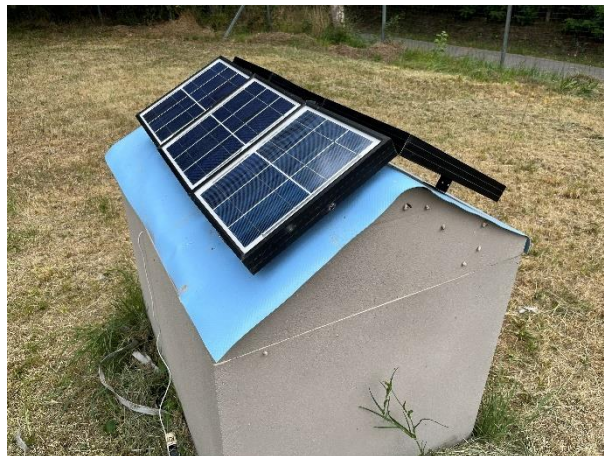
12.Ábra: Napelemek elrendezése a modellházon (saját kép)
