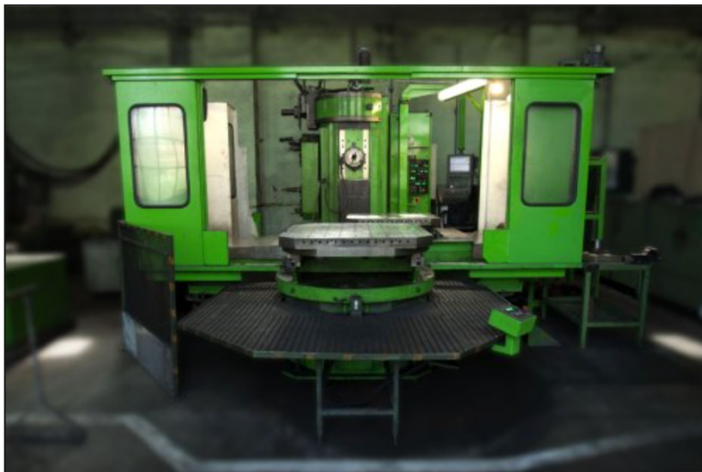
3.18. ábra YBN 90 N CNC X=2.000 mm Y=2.000 mm Z=800 mm [29.]
