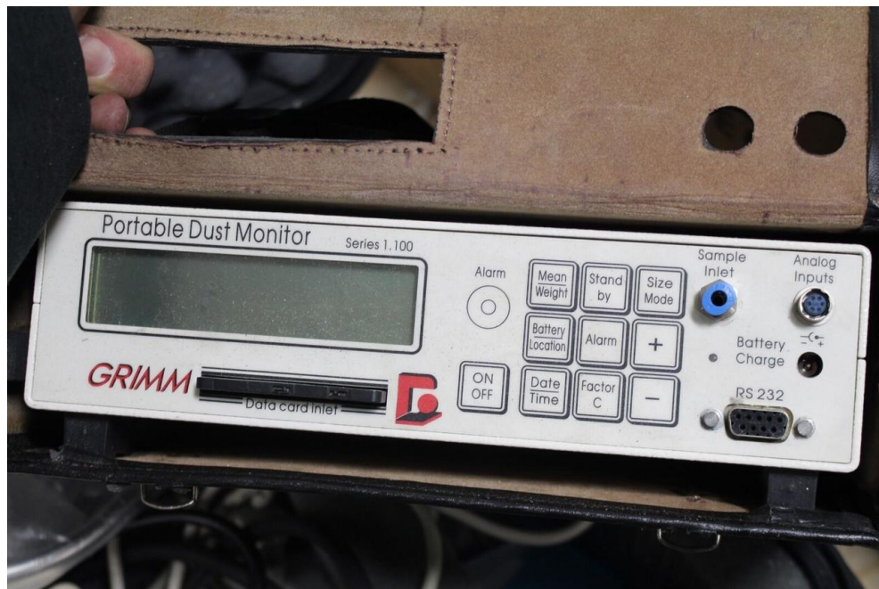
5.ábra - Szálló por koncentrációinak mérésére használható műszer (Fotó:Pápai Dóra, Gödöllő, 2021.08.12.)
