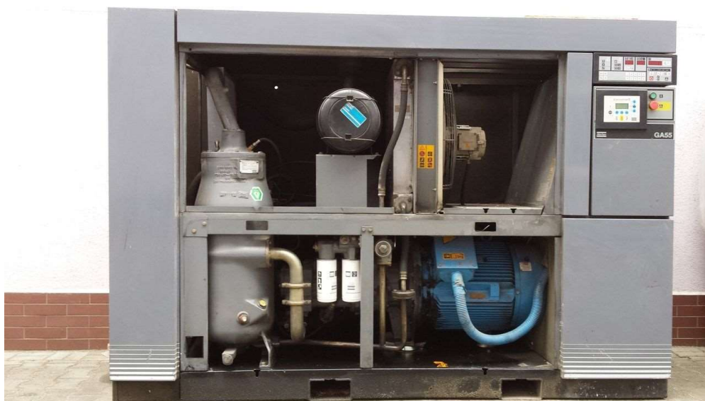
14. ábra: Atlas Copco GA 55 csavarkompresszor
