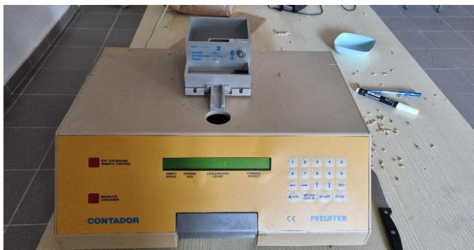
17.ábra ezermagtömeg mérés
