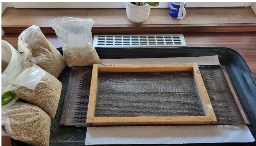
18. ábra: Őszi árpa minták rostálása 2 mm-es hasíték rostával
