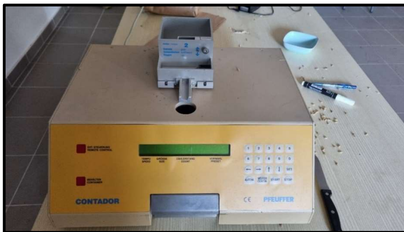
15. ábra: Pfeuffer Contador magszámláló
