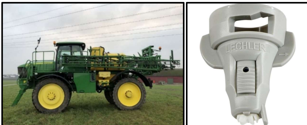
10. ábra: JD 5430 permetező és a Lechler IDTA fűvóka
