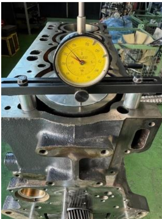
5.30 ábra Dugattyú kiállás mérése (saját fotó)
