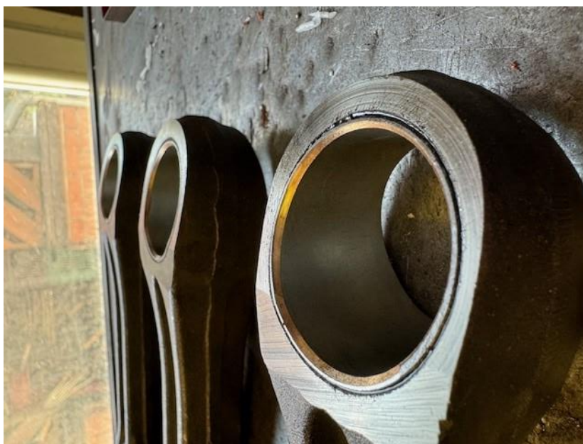
5.25 ábra Az új dugattyúcsapszeg persely a hajtókarban (saját fotó)
