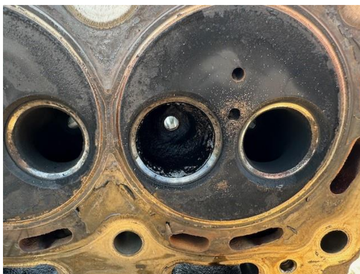
5.2 ábra Szelepkamrák szennyeződéssel (saját fotó)
