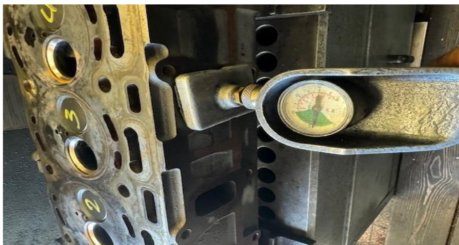
5.20 ábra Szelepszárás ellenőrzés (saját fotó)
