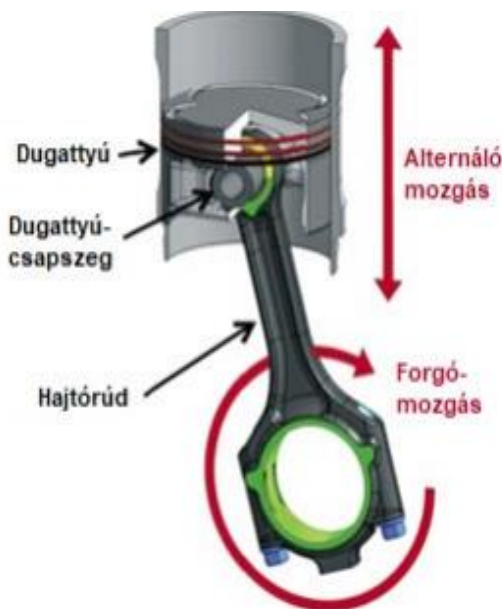
3.6 ábra Forgattyús mechanizmus
