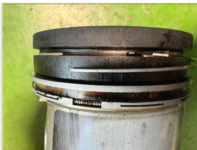
5.8 ábra kopott dugattyú törött gyűrűkkel (saját fotó)
