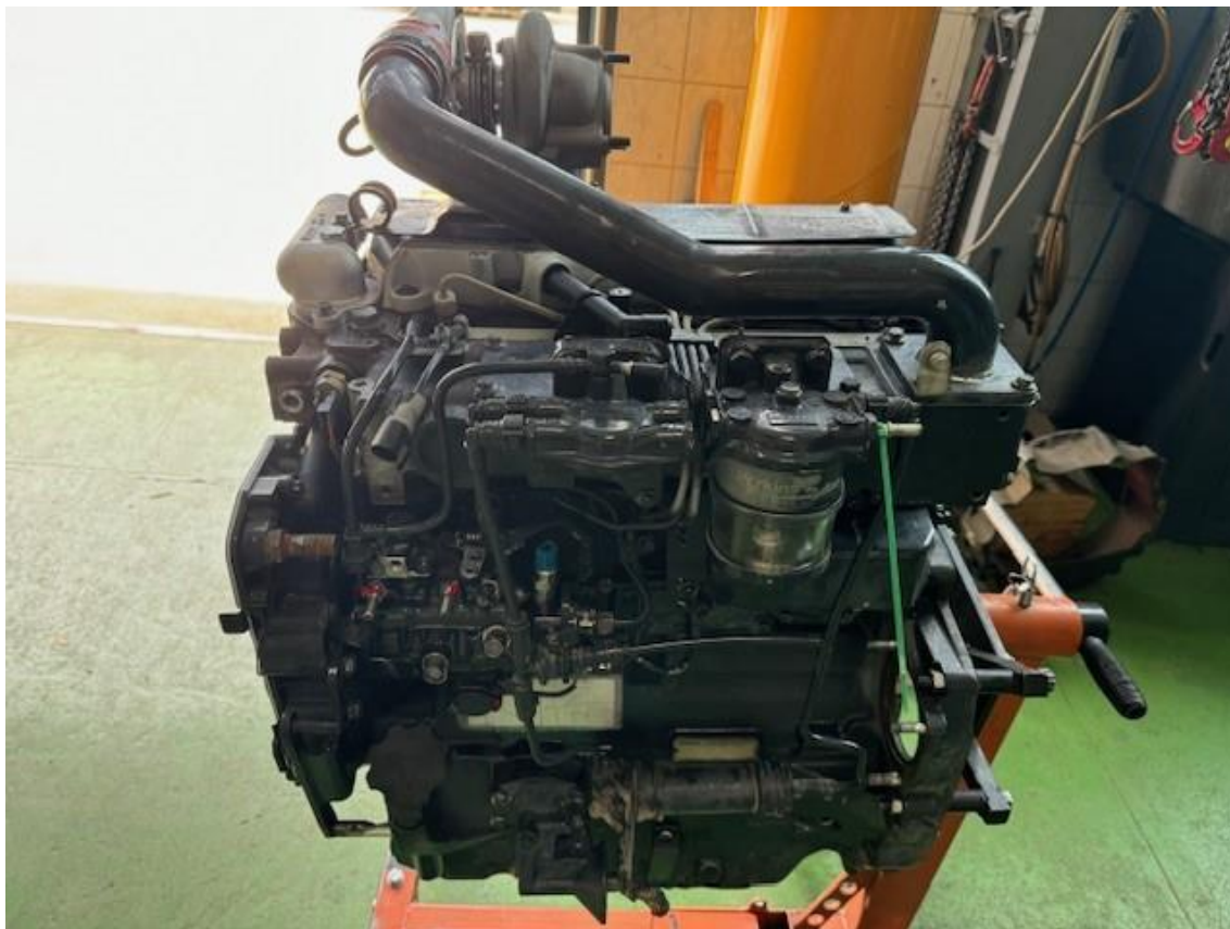
5.35 ábra A motor a felújítás utáni összeszerelt állapotában (saját fotó)
