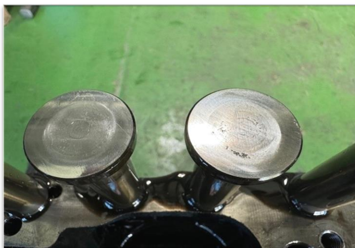
5.9. ábra szelepemelő tökéék fáradásos kopása (saját fotó)
