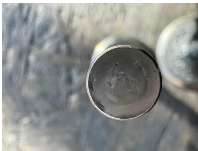
5.10 ábra a szelep végének pittinges kopása (saját fotó)
