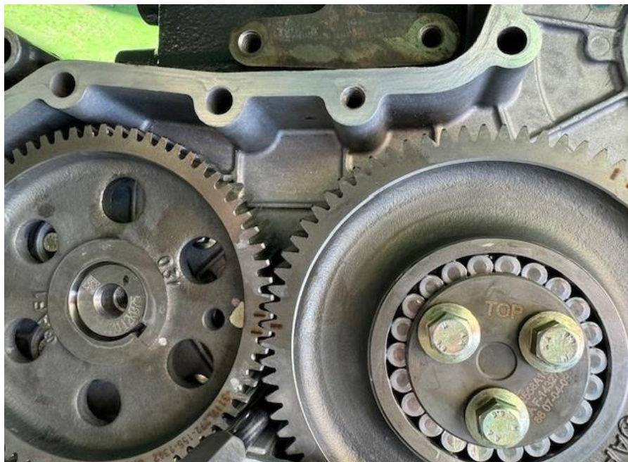
5.32 ábra A motor fogaskerék vezérlése (saját fotó)
