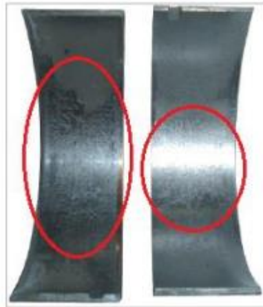
3.4 ábra Fáradásos kopás jelei belső égésű motor hajtókarcsapágyn (forrás: Ráthy I., Fazekas L., Gavallér J., Kugyela P. (2015) Karbantartás és gépjavítás)
