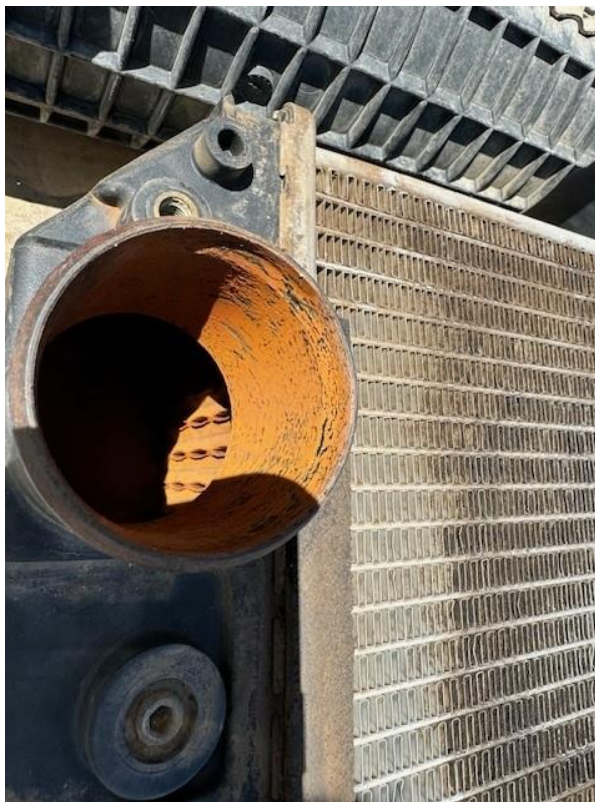
4.4 ábra Vízhűtő kicsapódott ásványi anyagokkal (saját fotó)
