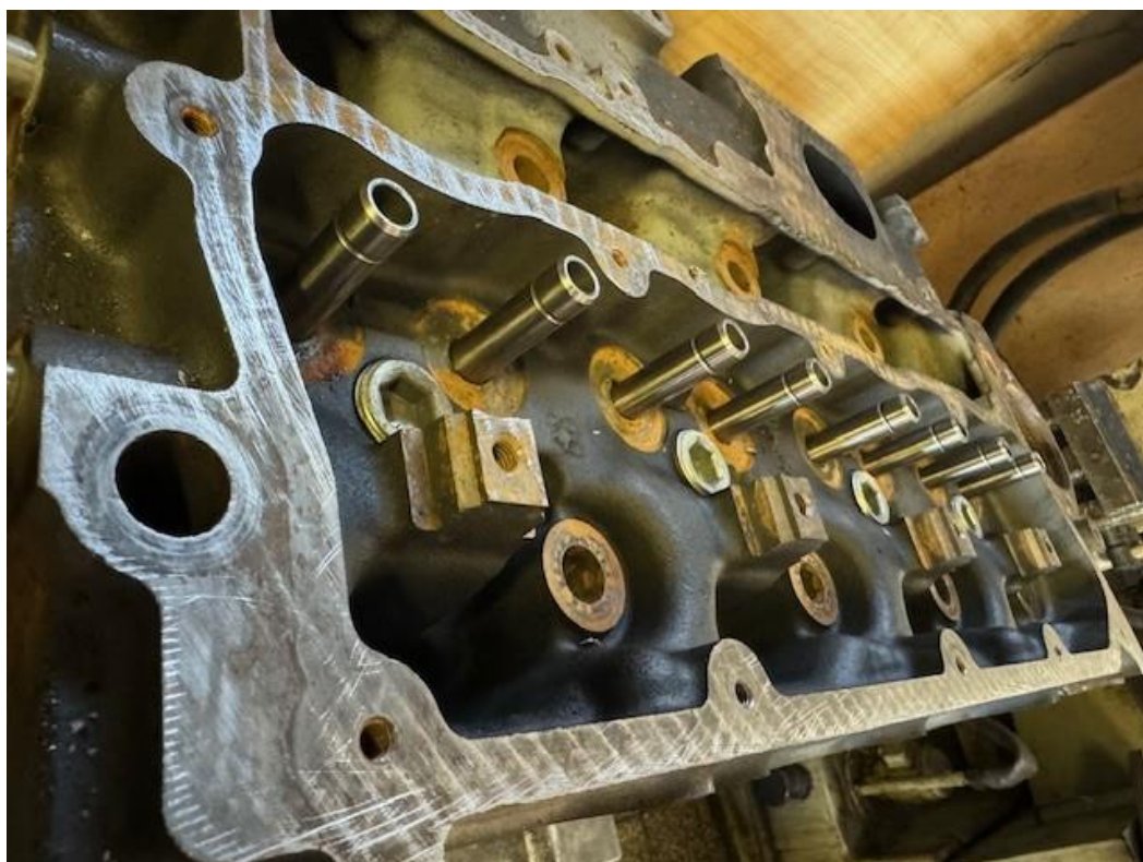
5.17 ábra Szelepvezetők illesztése (saját fotó)
