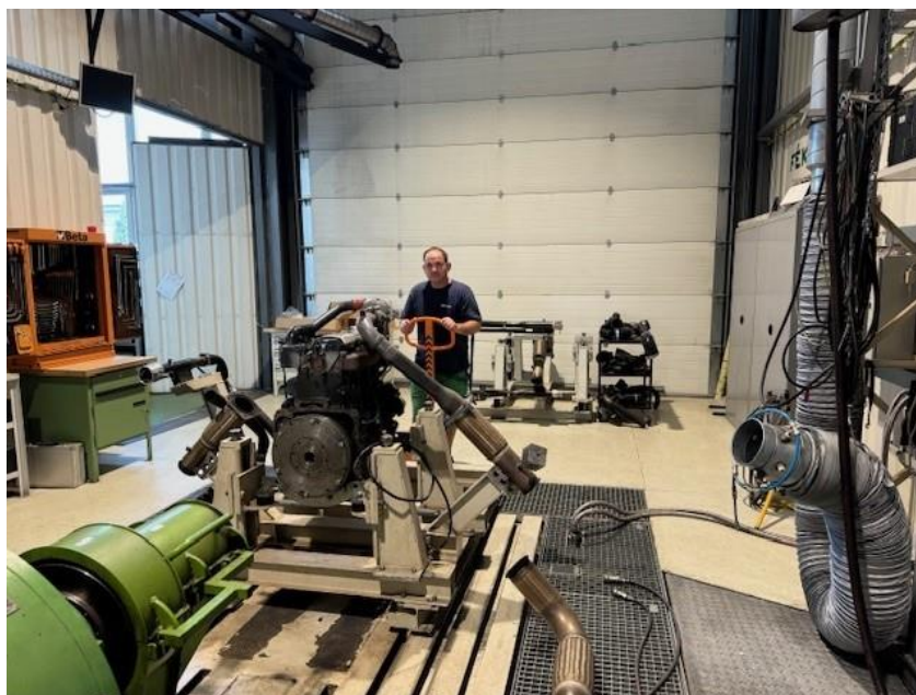
5.37 ábra A motor csatlakoztatása a fékpadi terheléshez (saját fotó)
