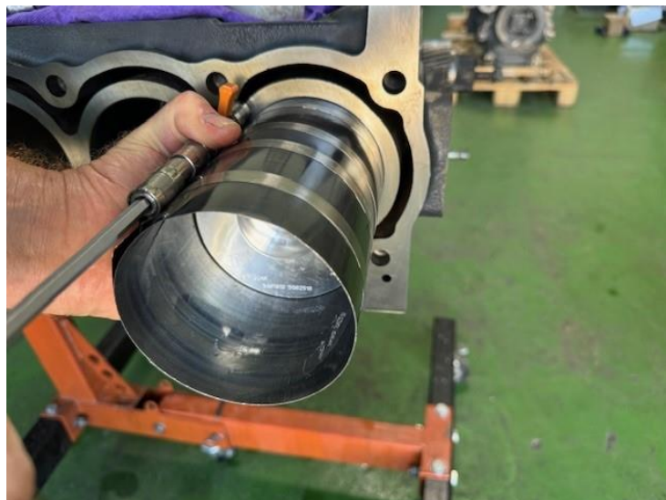
5.29 ábra Dugattyú beépítése (saját fotó)
