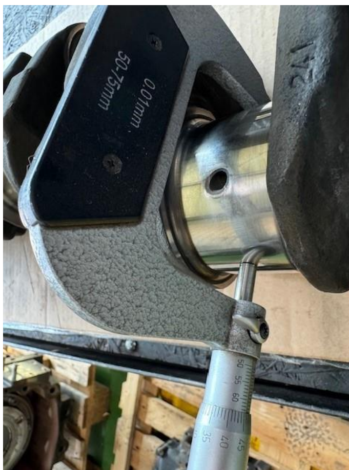
5.11. ábra Főtengely mérés (saját fotó)
