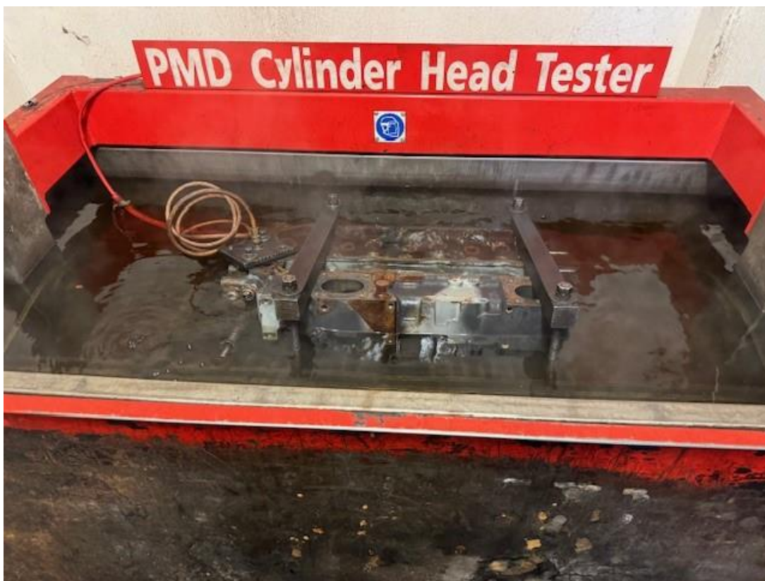
5.16 ábra Hengerfej nyomáspróba (saját fotó)
