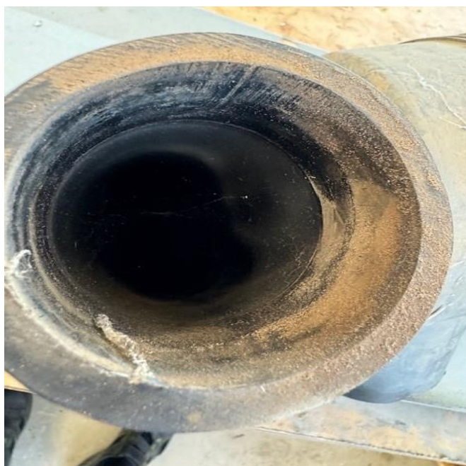
4.3 ábra Szívórendszerben por lerakódás (saját fotó)
