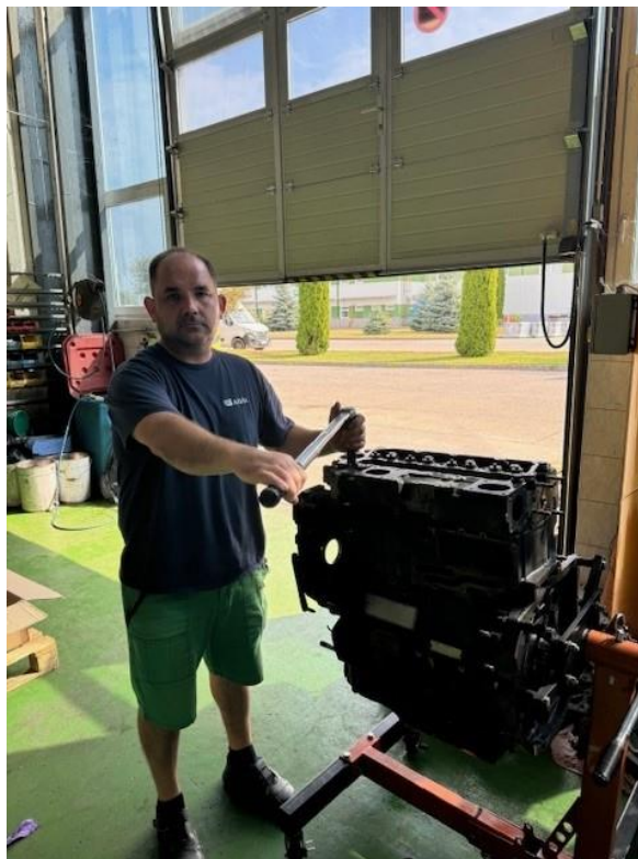
5.34 ábra A hengerfejecsavarak nyomatékra húzása (saját fotó)
