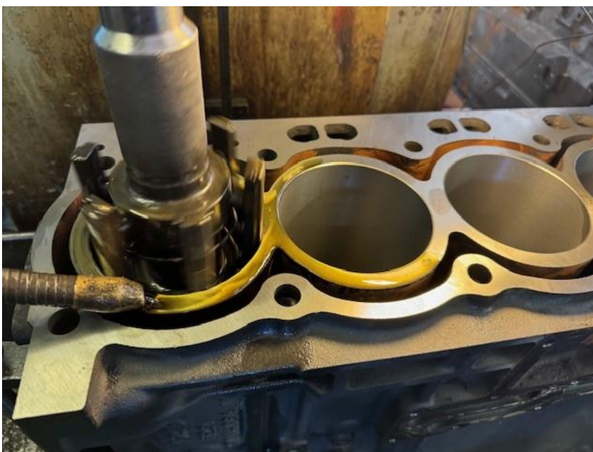
5.24 ábra Henger hónolási folyamat (saját fotó)
