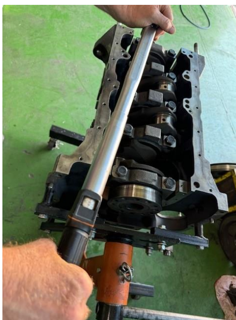
5.28 ábra Főtengely csapágyfedeleinek nyomatékra húzása (saját fotó)
