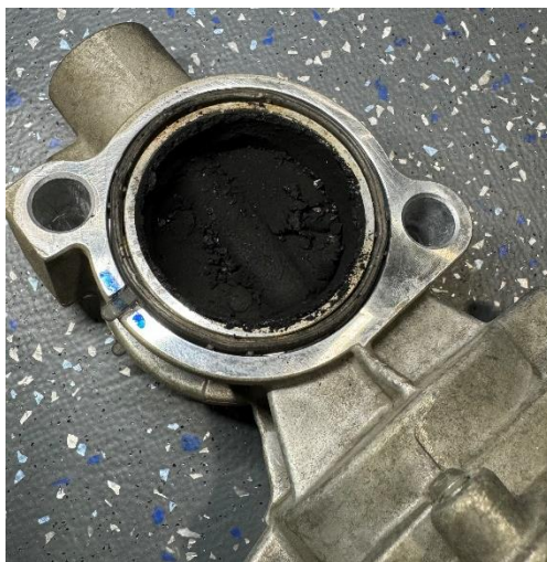
15. ábra: Meghibásodott EGR szelep
