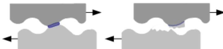
3. ábra Adhéziós kopási folyamat
