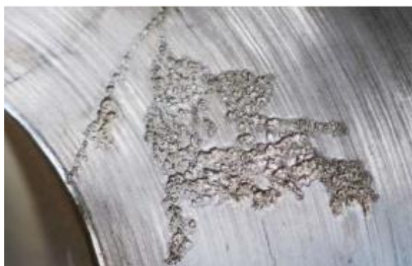
10. ábra Kavitációs kopás [5]
