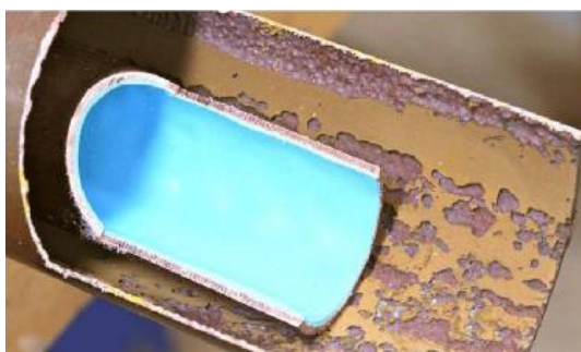
9. ábra Eróziós kopás [5]
