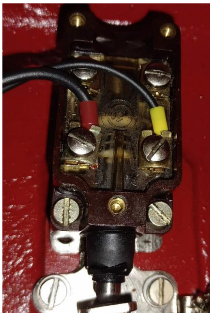
15. ábra Gyártó által beépített végálláskapcsoló
