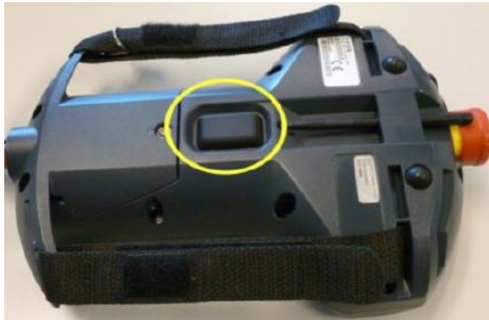
18. ábra Engedélyező kapcsoló (Deadman switch) (saját fotó)
