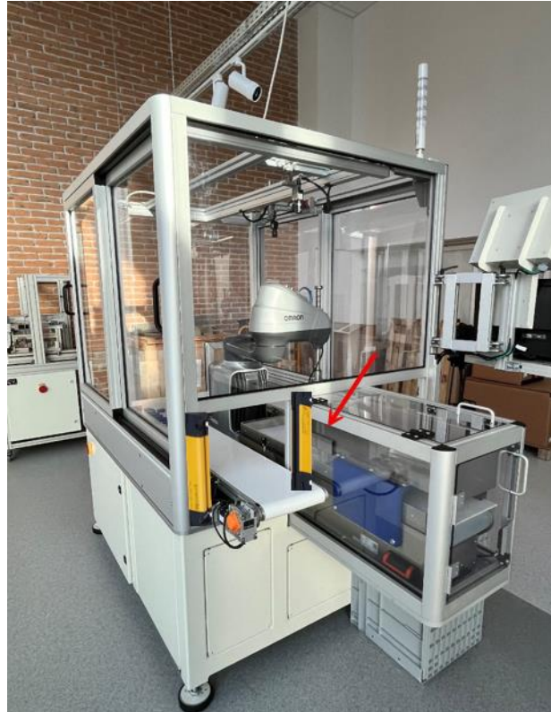
33. ábra A fényfüggönyök a robotcellán (saját szerkesztés)
