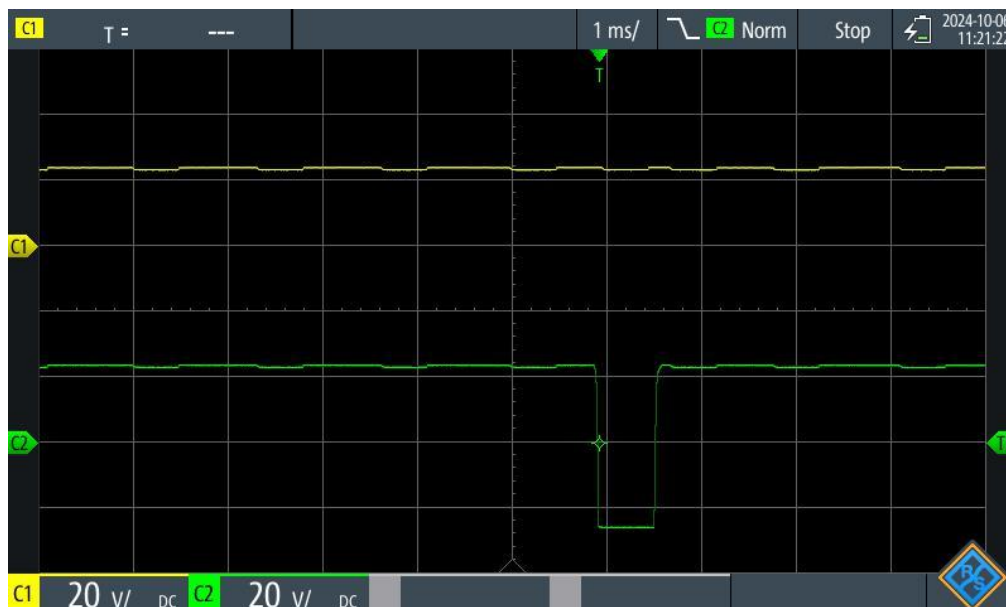
23. ábra: Biztonsági kimeneti kártya teszt funkcióinak kimérése [saját mentés műszerről]
