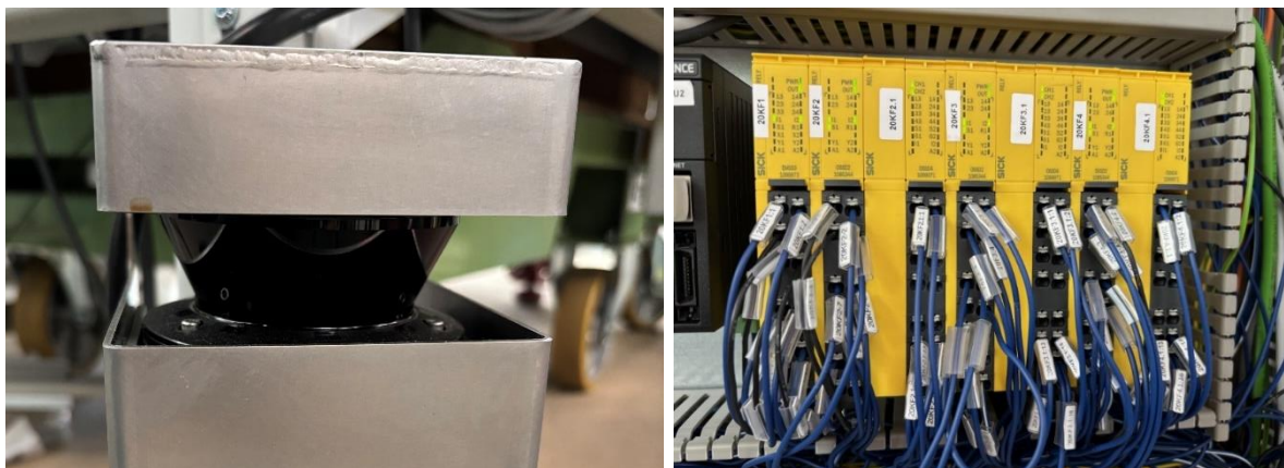
15. ábra A beépítésre került SICK biztonsági szkennerek [saját készítés]
