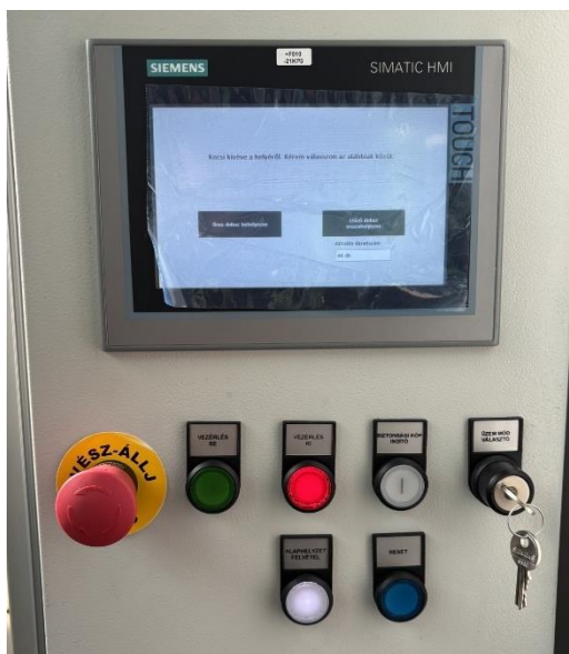
14. ábra VÉSZSTOP gomb elhelyezkedése [saját készítés]
