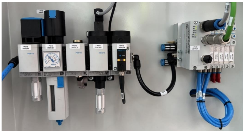
11. ábra A csomagoló robot levegő előkészítő egysége [saját készítés]
