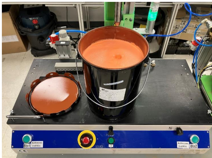
2. ábra Tgél-es vödör elhelyezése [saját készítés]
