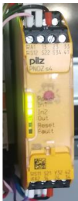
9. ábra: PILZ PNOZ s4 biztonsági relé (Saját készítés)
