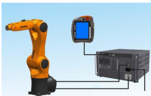
6. ábra: A robotvezérlő, Manipulátor, smartPAD csatlakoztatása [14]
