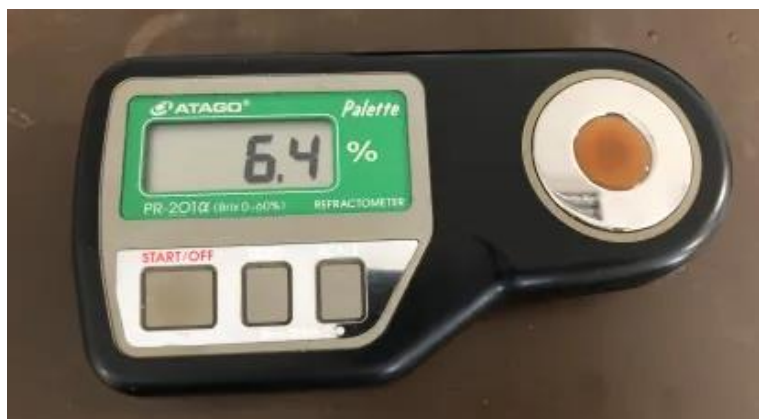
13. kép: °Brix tartalom mérés. (Forrás: Saját fénykép)
