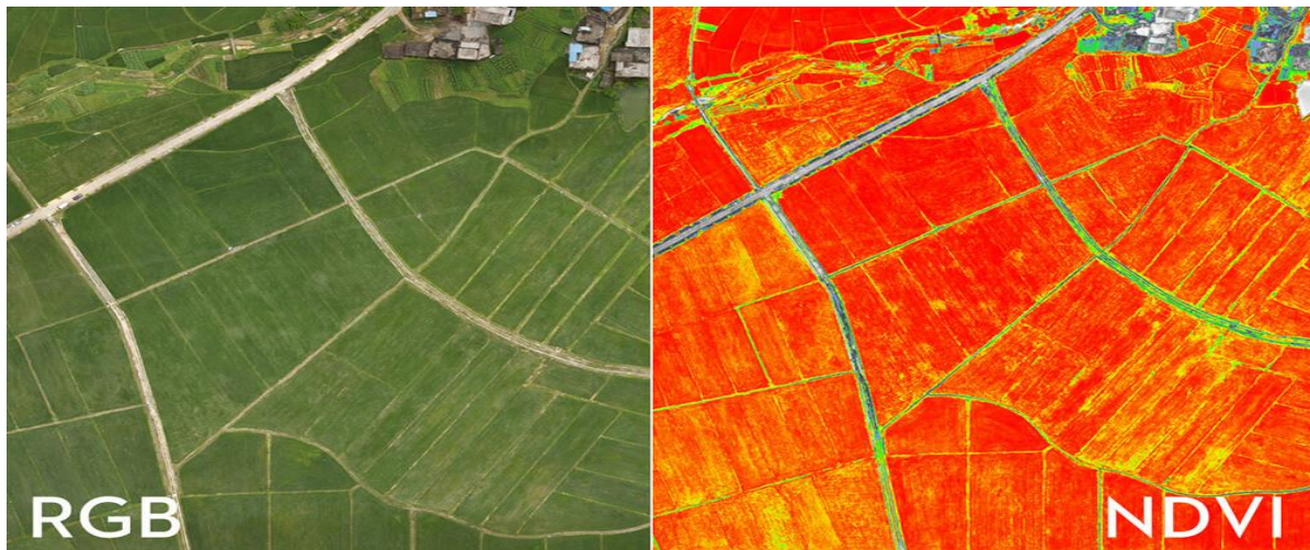
4. ábra: DJI Phantom 4 multispektrális kamera felvétele (Forrás: ( http1 ))
