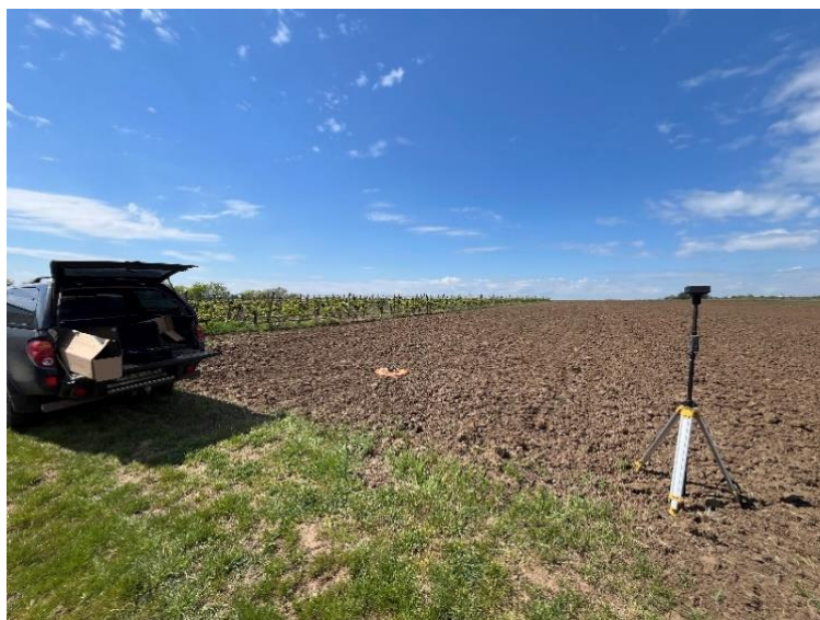
3. ábra: DJI D-RTK 2 bázisállomás felmérés közben (Forrás: Saját fotó 2024)
