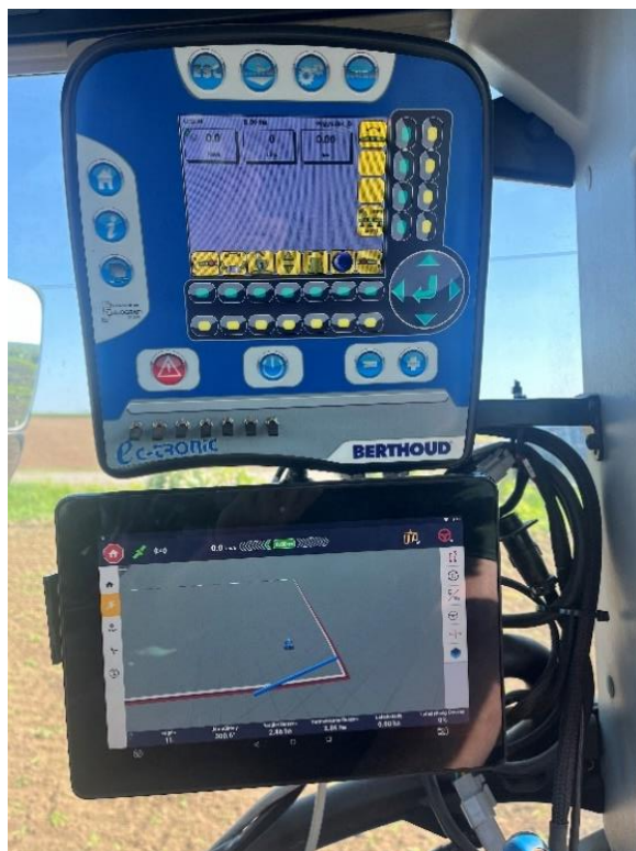
7. ábra: Robotkormány és permetező vezérlő monitorok (Forrás: Saját fotó 2024)
