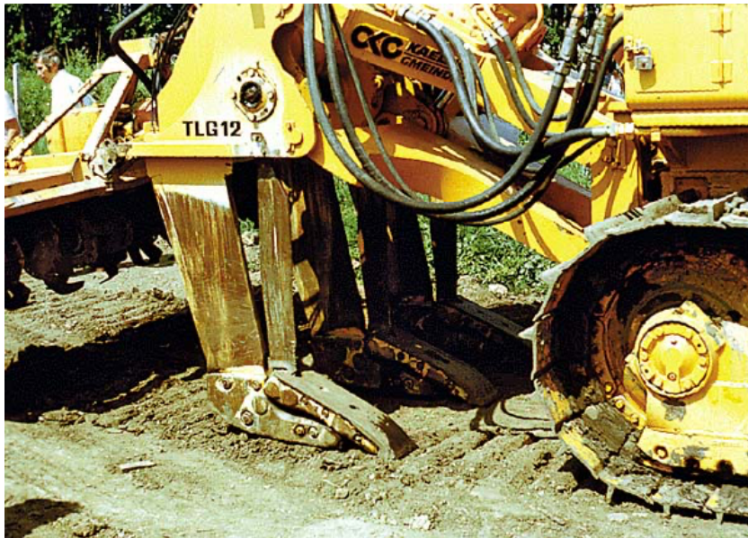
5. ábra Alatlajlazító munkagép acélkései
