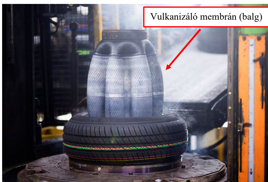
15. ábra: Abroncs vulkanizálóbalg (bladder) [34]
