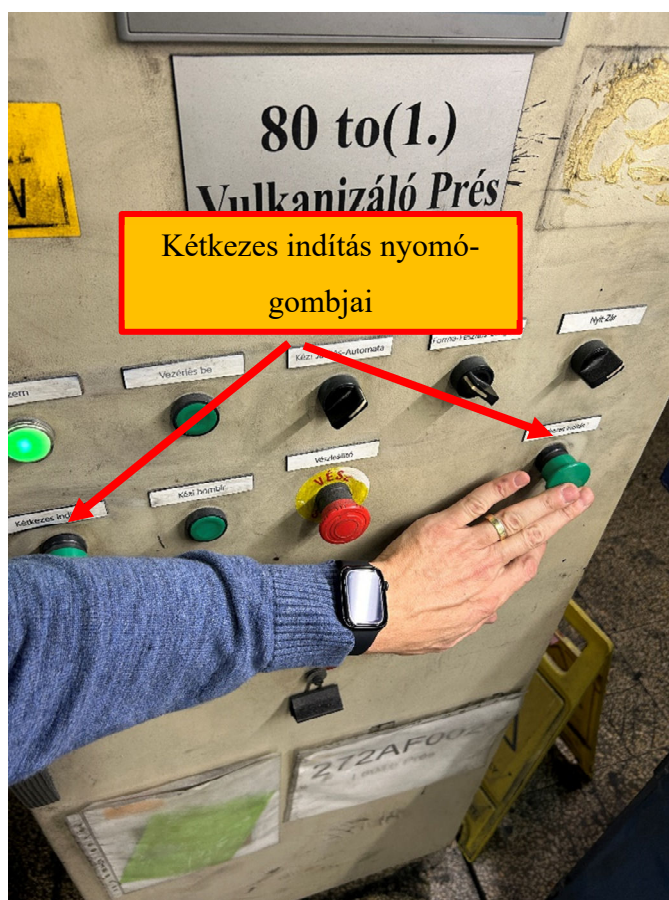
25. ábra: Kétkezes indító kialakítása a vulkanizálógépen
