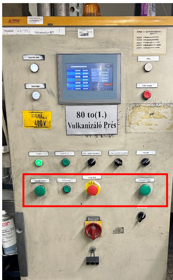
25. ábra: Kétkezes indító kialakítása a vulkanizálógépen
