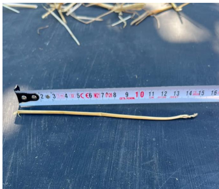
33. ábra Claas Lexion 8800-as által aratott búza hossza (forrás: saját kép)
