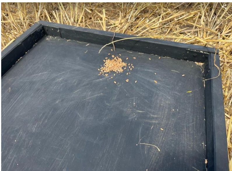
21. ábra Lexion 8800-as kombájn által elszórt magok mennyisége 0,25m 2 -en (forrás: saját kép)
