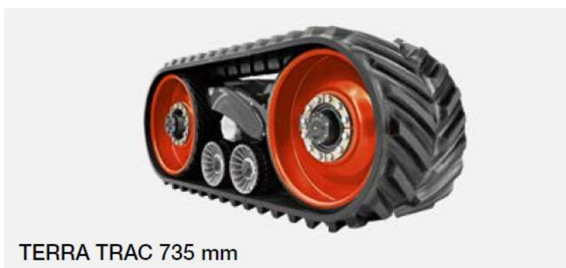
27. ábra: Terra Trac járószervezet 735 mm széles gumihevederrel
