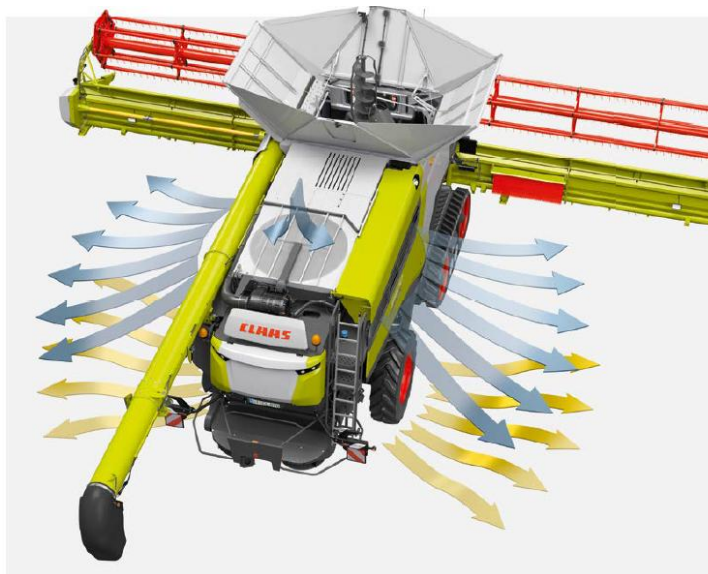
25. ábra: Dynamic Cooling hűtési technológia
