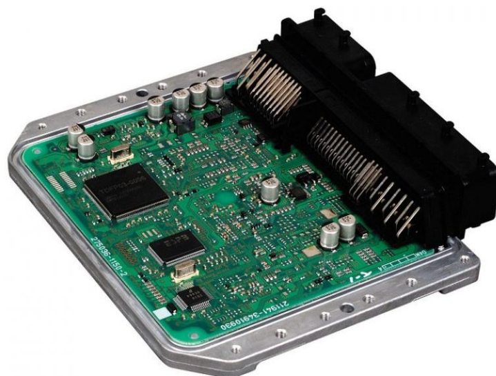
2.3. ábra: Gépjárművek vezérlőegységének belső felépítése ( http4 , 2024.08.26.)
