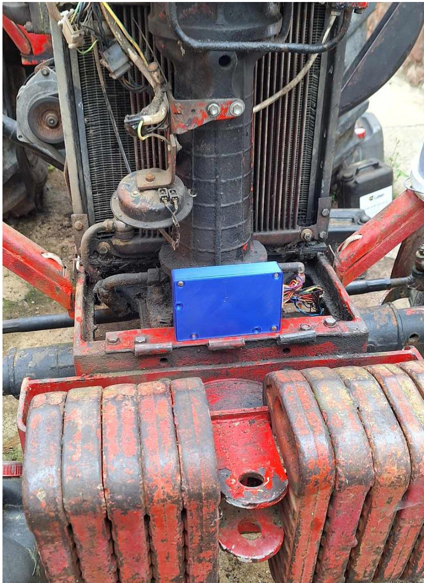
3.19. ábra: A mérőelektronika elhelyezése
