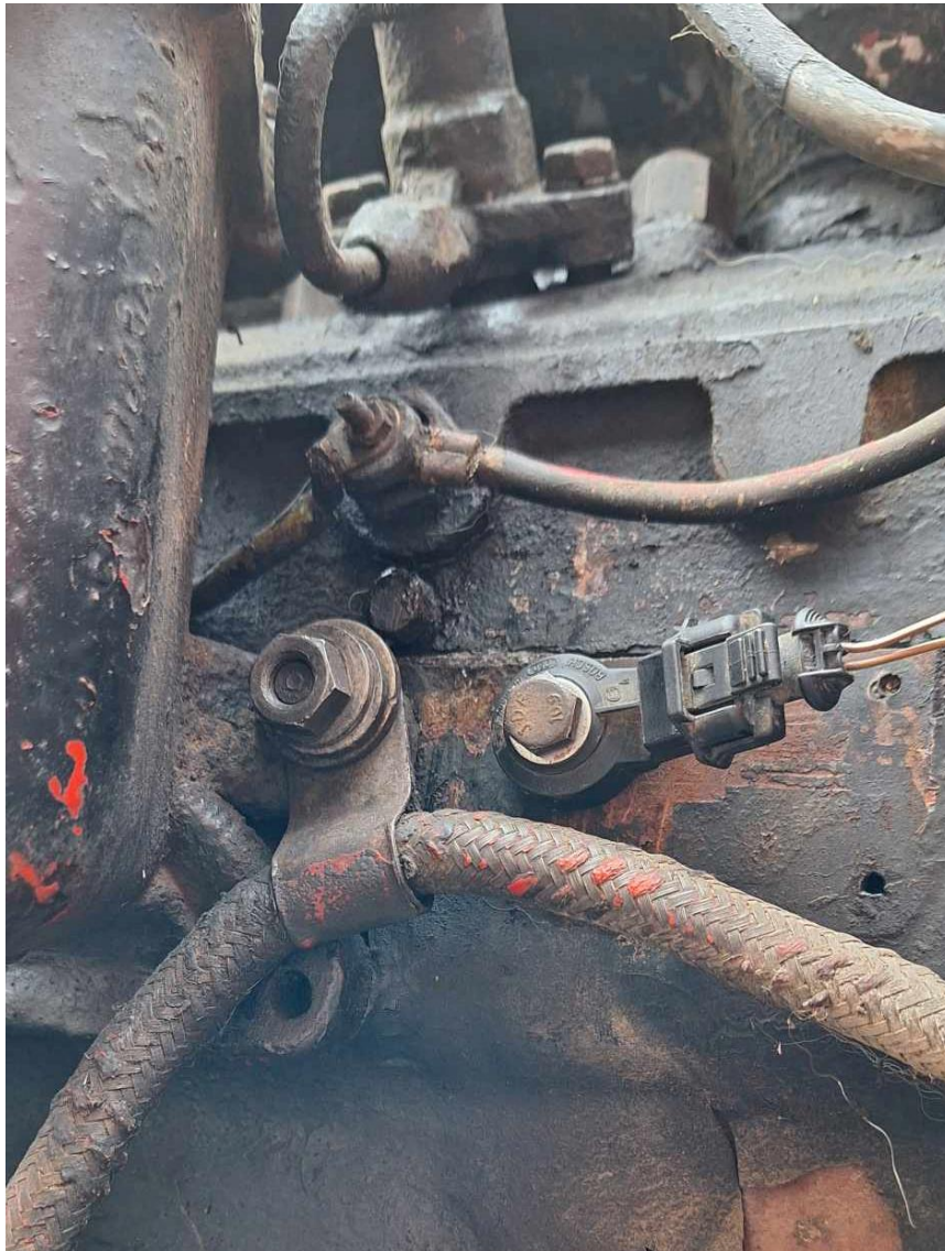
3.21. ábra: A kopogásérzékelő elhelyezése
