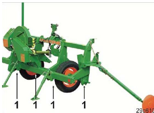
20. ábra: Zsírozandó csapágys Forrás: Amazone ED 452-k kezelési útmutató
