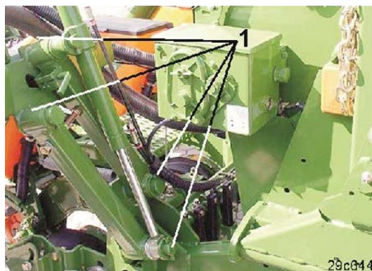
21. ábra: Zsírozandó csapok Forrás: Amazone ED 452-k kezelési útmutató
