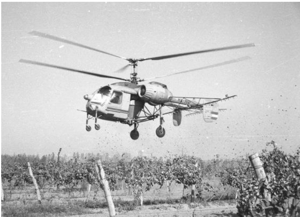
2. ábra: Szőlő permetezés Kamov Ka-26 típusú helikopterrel (Lesz-e jövőjük, 2020)
