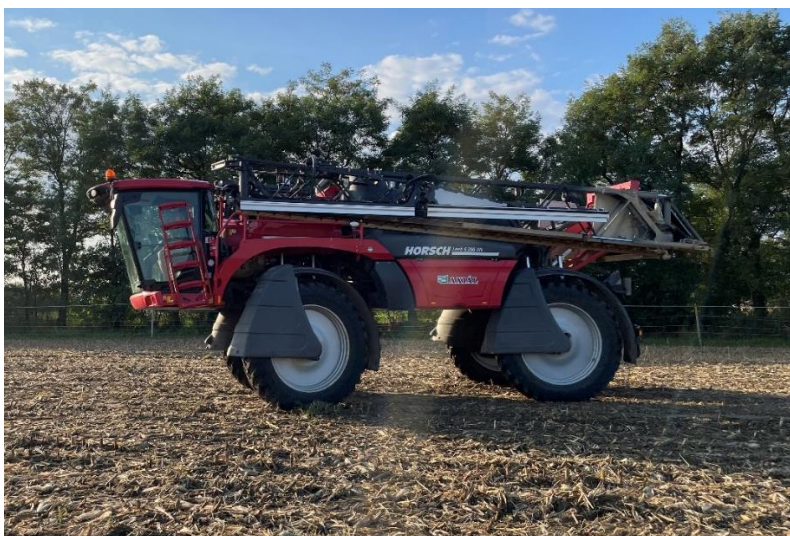
10. ábra: A kísérlet eszköze, a Baki Agrárcsoport 30 méteres munkaszélességű Horsch Leeb 6.300 VN típusú hidas permetező gépe (Forrás: Saját)
