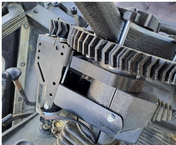
12. ábra 24 voltos motor rögzítése (Forrás: Saját kép)
