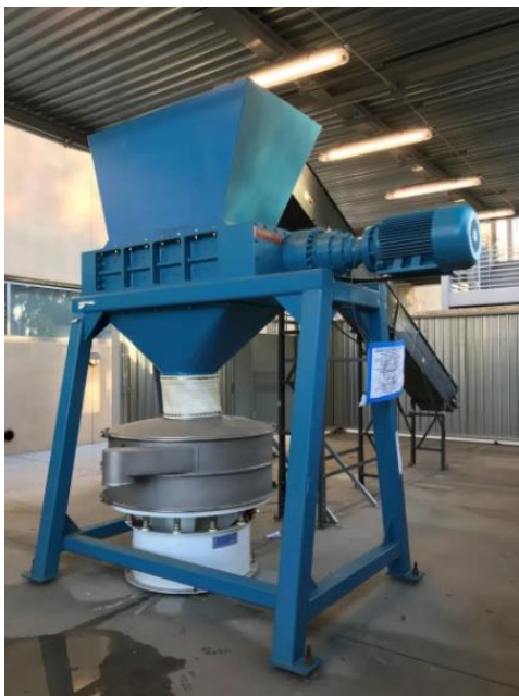
5.ábra Ipari hulladékpapír daráló futószalaggal (Franklin Miller, N.a.)
