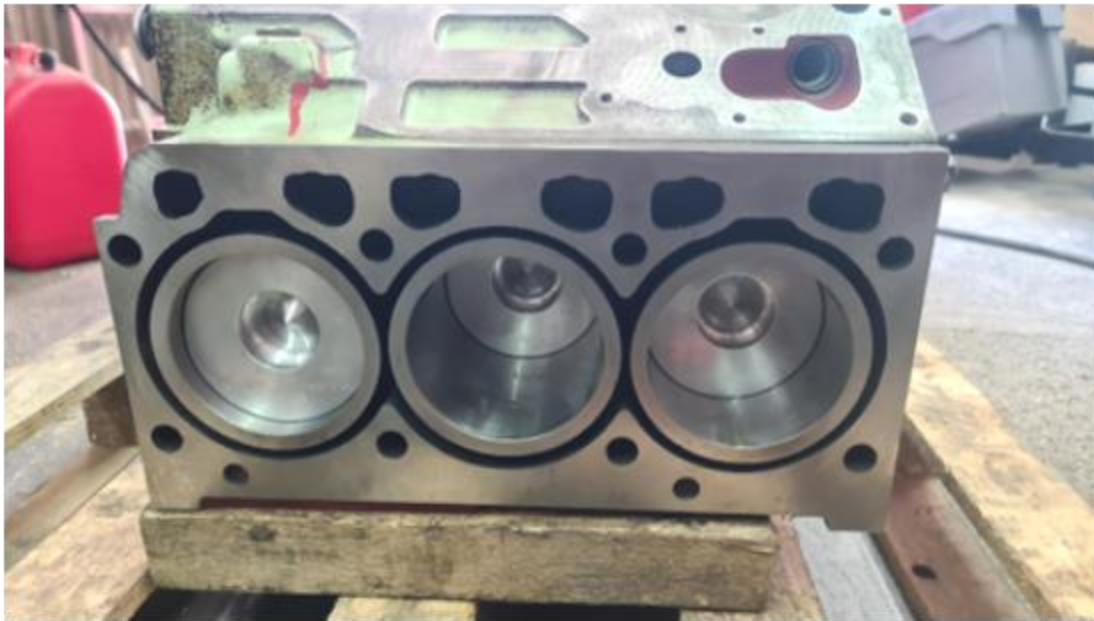
20. kép Motorblokkba befűzött dugattyúk
