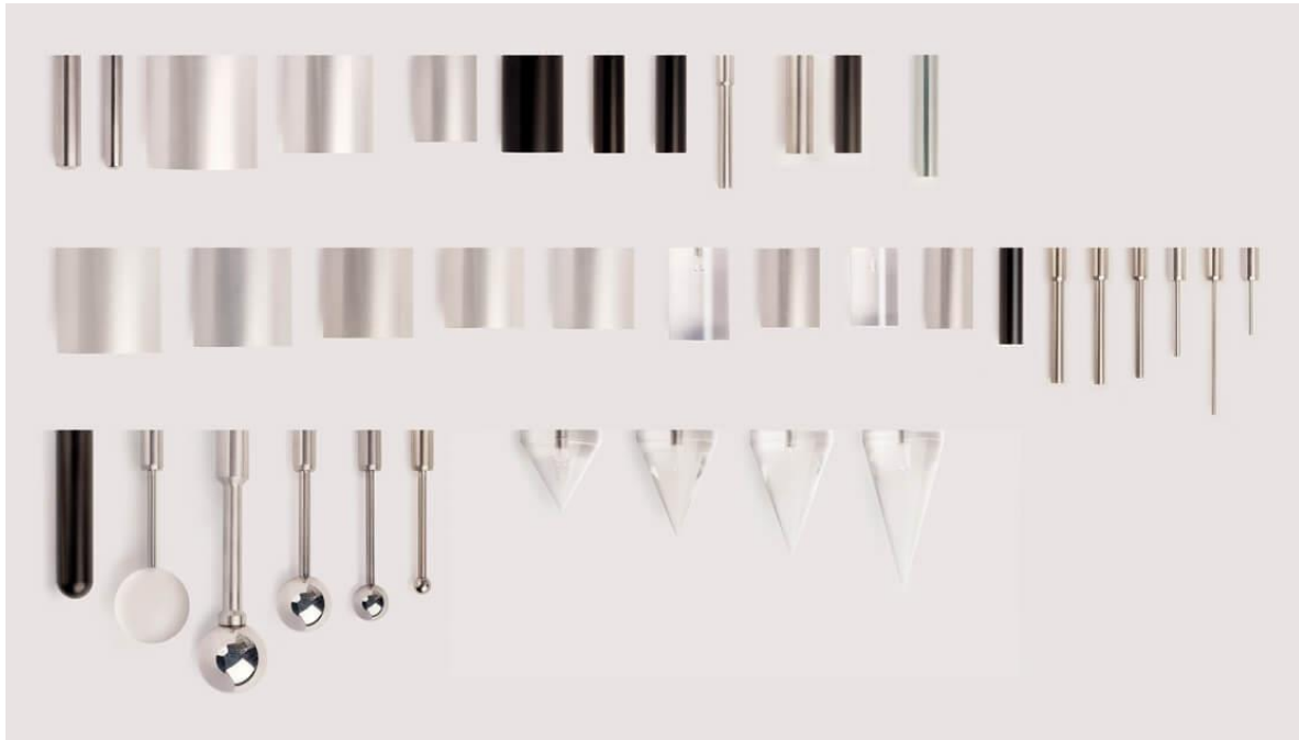
10. ábra: SMS TA.XT készülékekhez használható mérőfejek ("stablemicrosystems.com," n.d.)
