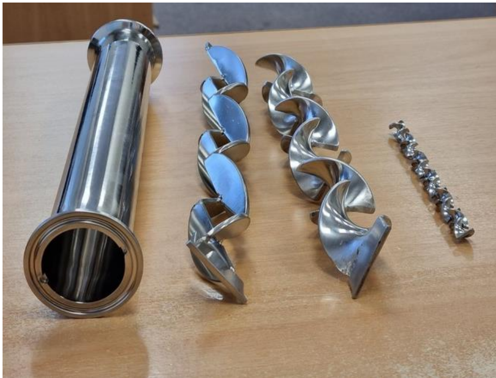
4. ábra: Csővezetékbe építhető keverő-habaró elemek ("hdprocess.co.nz," n.d.)
