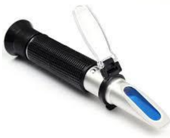
20. ábra: Kézi refraktométer (Forrás: https://bodomeheszet.hu/boraszati-refraktometer )
