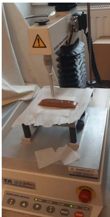
4. ábra Stable Micro Systems TA-TX plus penetrométer mérés közben (Forrás: Saját munka)
