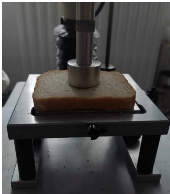
2. ábra: A kenyérszelet keménységének mérése (Forrás: saját kép)
