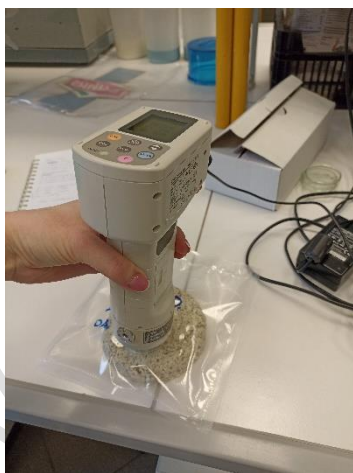
12. ábra: Minolta CR-400 készülékkel színmérés (forrás: saját fénykép)
