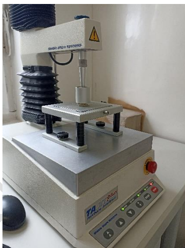
14. ábra: SMS TA.XT.Plus állománymérő készülék, mérés közben (forrás: saját fénykép)
