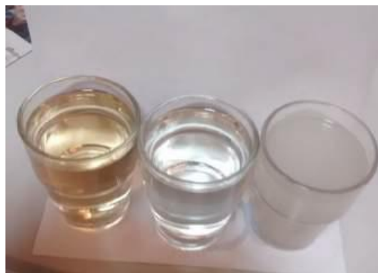
16. ábra. Balra: Feketevíz-tisztító berendezés NPK folyékony műtrágya előállításához, RWF pilot berendezés. Jobbra: (jobbról balra haladva), szürkevíz, üzemvíz (kezelt szürkevíz), aranyvíz (feketevíz-tisztításból származó folyékony műtrágya). Forrás: (Million és mtsai. 2018, 28)
