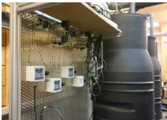
16. ábra. Balra: Feketevíz-tisztító berendezés NPK folyékony műtrágya előállításához, RWF pilot berendezés. Jobbra: (jobbról balra haladva), szürkevíz, üzemvíz (kezelt szürkevíz), aranyvíz (feketevíz-tisztításból származó folyékony műtrágya). Forrás: (Million és mtsai. 2018, 28)
