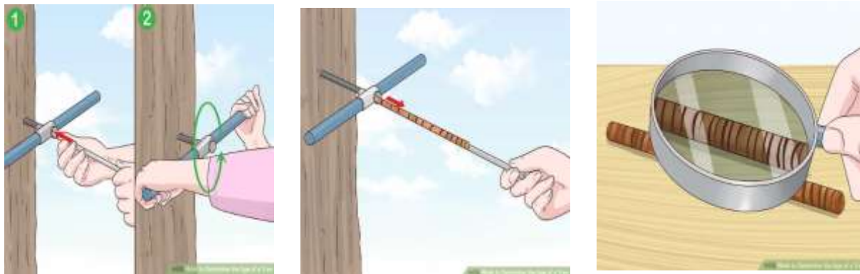
21. ábra: Pressler féle növedékfúró használata (Forrás: wikihow.com) Internet 19
