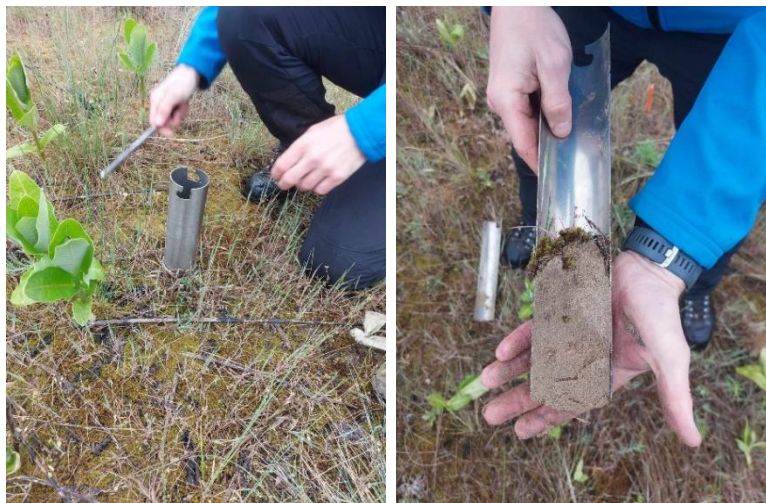
2. ábra Talajmintavevő használata (bal oldalon), talajminta (jobb oldalon).
