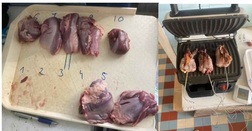
25. kép: A minták sütése 72 °C-os maghőmérséklet eléréséig.
