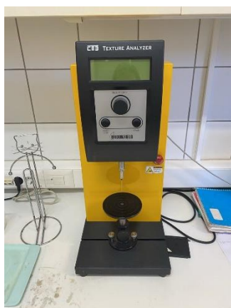
13. ábra: Brookfield CT3 Texture Analyzer készülék a gyümölcskeménység méréshez (forrás: Csap L.)
