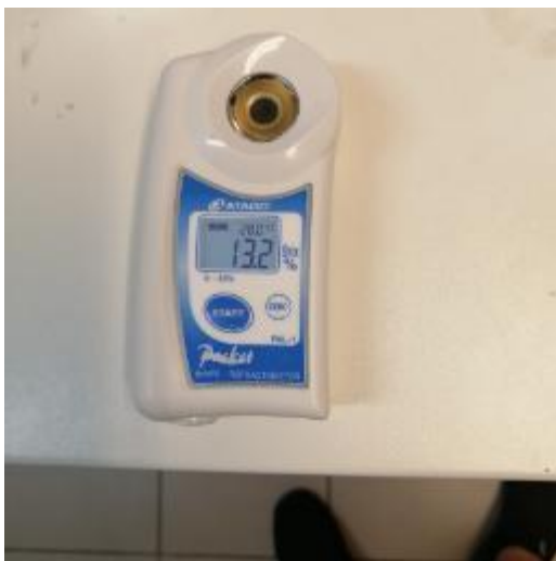
12. ábra, kézi digitális refraktométer, cukortartalom mérése, saját felvétel 2023 szeptember
