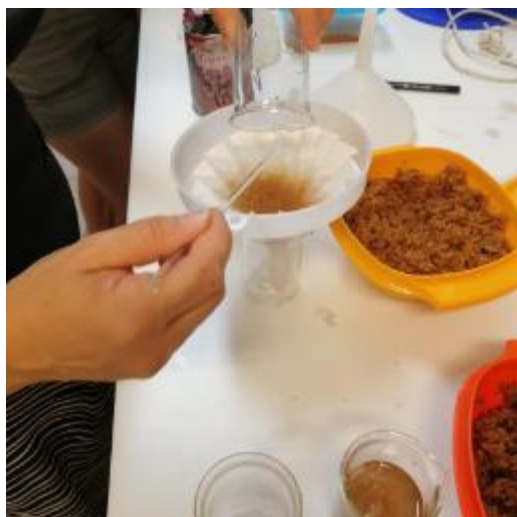
10. ábra, az oldat előkészítése a savtartalom méréséhez, saját felvétel 2023 szeptember
