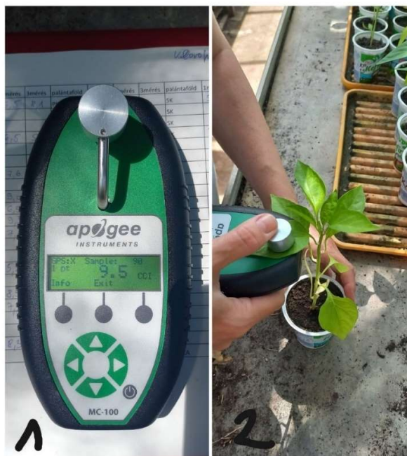
ábra 3: klorofill mérés; 1.kép: klorofill mérő készülék; 2. kép: klorofill mérés folyamata; Képeket készítette: Divéky-Ertsey Anna
