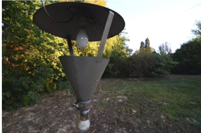
10. ábra: A szekszárdi Jermy-típusú fénycsapa (Forrás: Mosonyi Szabolcs)
