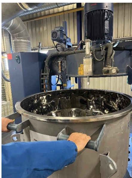
5. ábra Keverő betolása a fej alá (forrás: saját fotó)
