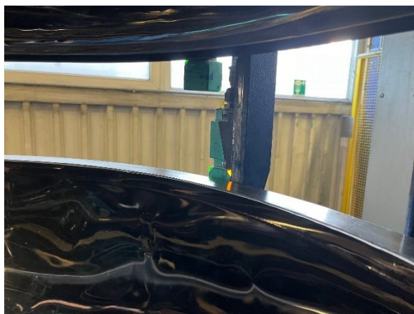
6. ábra Végállás kapcsoló visszajelző lámpája (forrás: saját fotó)
