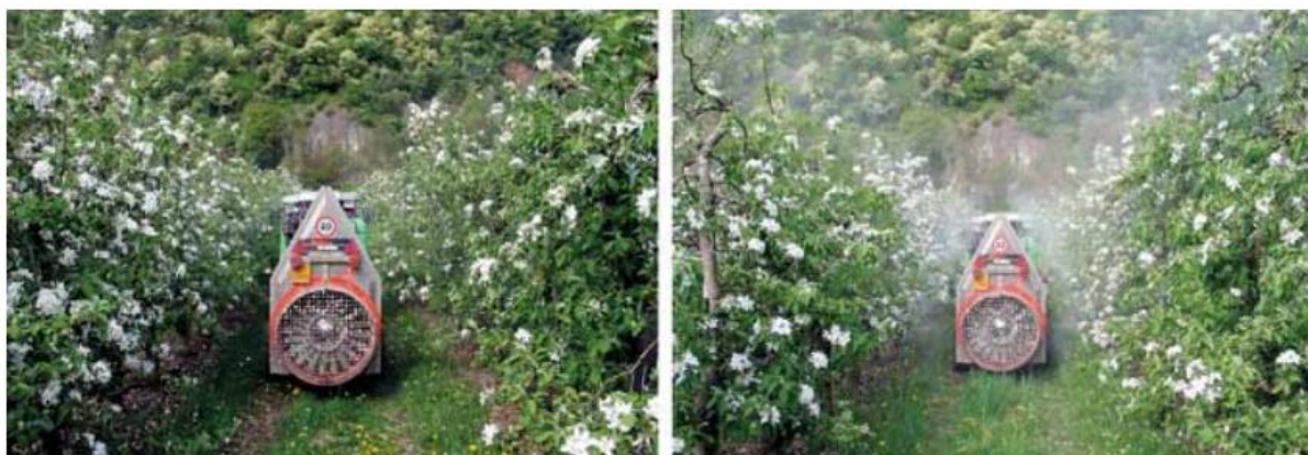
2. ábra: A permetléköd jobbra Lechler ITR 80 015, balra standard ATR fúvókák használata során Forrás: ACLER et al. (2013)
