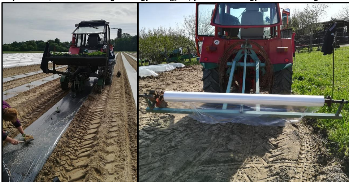
4. ábra: Az ültetés folyamata (bal oldal), a fólia húzó szerkezet (jobb oldal) (Saját képek)
